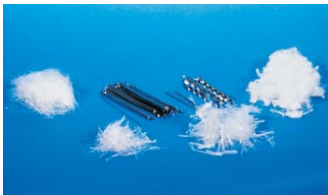
Fig. 7-1. Se pueden usar en concreto fibras de acero, de vidrio, sintéticas y naturales, con diferentes longitudes y formas. (IMG12412)
