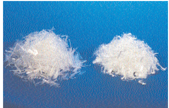
Fig. 7-7. Las fibras de polipropileno se producen como (izquierda) fibrillas finas con sección transversal rectangular o (derecha) monofilamentos cilíndricos. (IMG12403)
