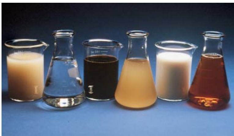
Fig. 6-1. Aditivos líquidos, de la izquierda hacia la derecha: aditivo anti-deslave, reductor de retracción, reductor de agua, agente espumante, inhibidor de corrosión y incorporador de agua. (IMG12188)
