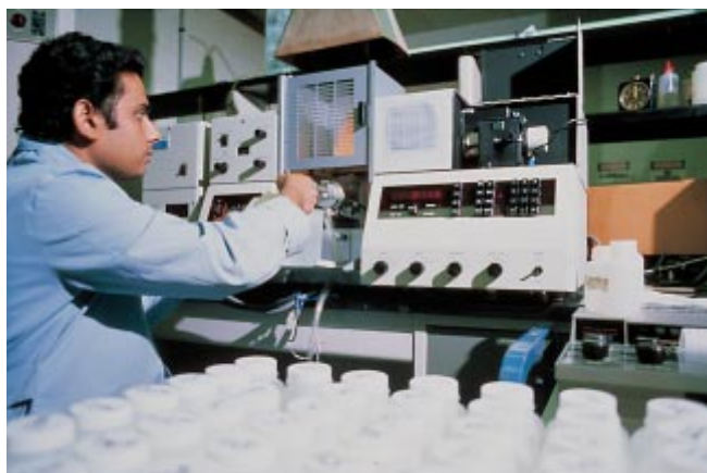
Fig. 4-2. Análisis de agua en laboratorio, en este caso usando un espectrofotómetro de absorción atómica para detectar la concentración de los elementos. (IMG12313)
