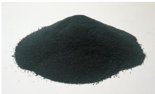
Fig. 3-7. Polvo de humo de sílice. ( IMG12192)
