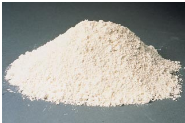
Fig. 3-11. La metacaolinita es una arcilla calcinada. (IMG12193)
