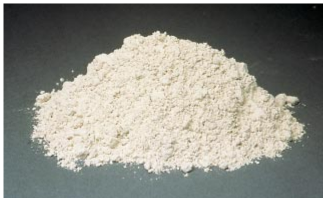
Fig. 3-5. Escoria granulada de alto horno molida. (IMG12191)
