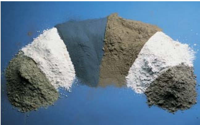
Fig. 3-1. Materiales cementantes suplementarios. De la izquierda para la derecha, ceniza volante (Clase C), metacaolinita (arcilla calcinada), humo de sílice, ceniza volante (Clase F), escoria y esquisto. (IMG12187)
