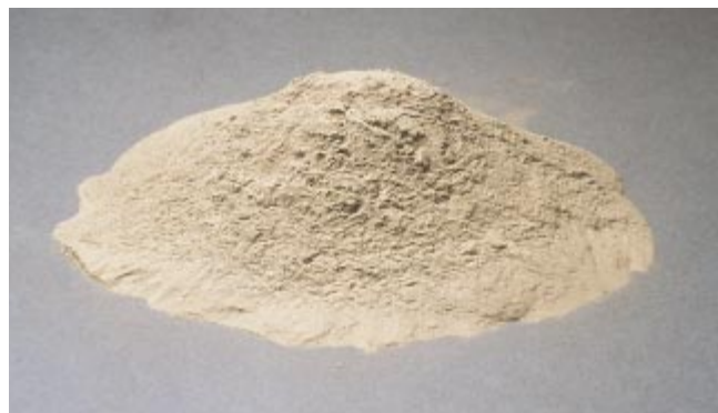
Fig. 3-3. La ceniza volante es un polvo que se parece con el cemento y ha sido usada desde los años 30. (IMG12190)
