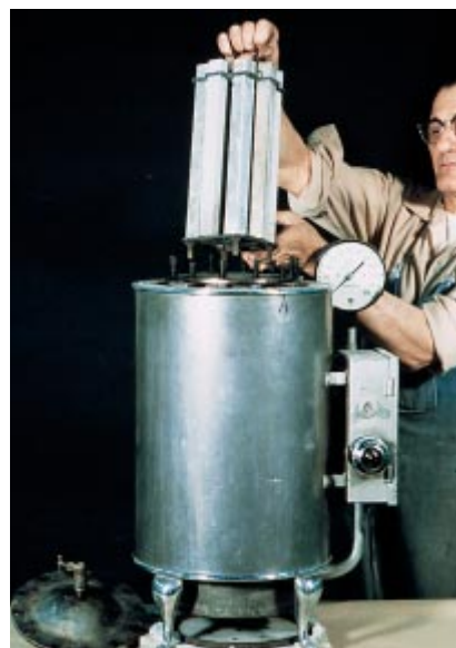
Fig. 2-35. En el ensayo de sanidad, las barras con sección cuadrada de 25 mm son expuestas a altas temperaturas y a la presión en autoclave para determinarse la estabilidad de volumen de la pasta de cemento. (IMG12454)
