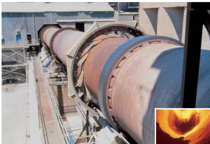
Fig. 2-8. Horno rotatorio para la manufactura del clinker de cemento. La foto menor, abajo y a la derecha trae una vista del interior del horno. (IMG12307, IMG12435)
