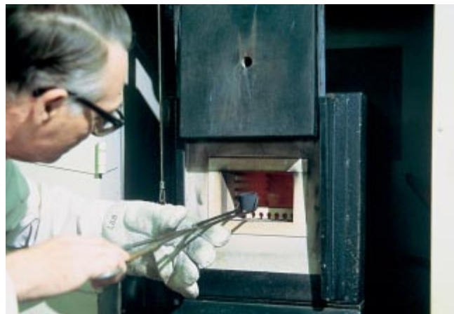
Fig. 2-46. Ensayo de pérdida por ignición del cemento. (IMG12305)
