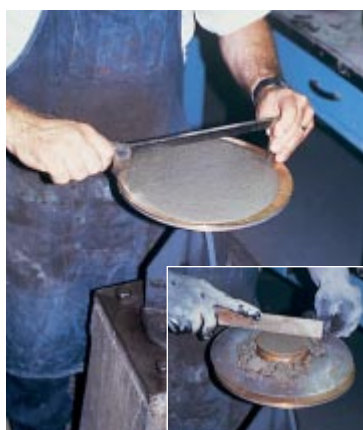
Fig. 2-37. Ensayo de consistencia para morteros usando la mesa de fluidez. El mortero se coloca en un molde de latón centralizado en la mesa (foto pequeña, a la derecha). El técnico debe usar guantes al manejar el mortero para la protección de su piel. Después que se remueve el molde y se somete la mesa a una sucesión de caídas, se mide el diámetro del mortero para determinarse la consistencia. (IMG12453, IMG12452)
