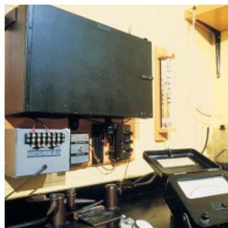
Fig. 2-32. Aparato del ensayo de Blaine (izquierda) y turbidímetro de Wagner (derecha) para la determinación de la finura del cemento. Los valores de finura de Wagner son un poco mayores que la mitad de los valores de Blaine. (IMG12303, IMG12458)
