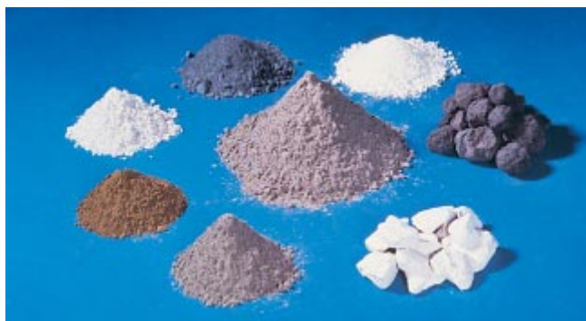
Fig. 2-19. Los cementos adicionados usan una combinación de cemento portland o clinker y yeso mezclados o molidos conjuntamente con puzolanas, escorias o ceniza volante. La ASTM C 1175 permite el uso y la optimización de todos estos materiales, simultáneamente si necesario, para producirse un cemento con propiedades óptimas. Se enseñan el cemento adicionado (al centro) rodeado por (derecha y en el sentido del reloj) clinker, yeso, cemento portland, ceniza volante, escoria, humo de sílice y arcilla calcinada. (IMG12473)
