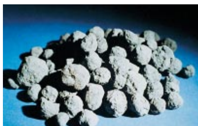
Fig. 2-9. El clinker de cemento portland se forma por la calcinación en el horno del material crudo calcáreo y sílice. Este clinker específico tiene un diámetro de 20 mm ( \frac{3}{4} pulg.) (IMG12434)
