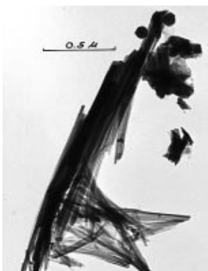
Fig. 2-26. Micrografías electrónicas de (izquierda) silicato dicálcico hidratado, (medio) silicato tricálcico hidratado y (derecha) cemento portland normal hidratado. Observe la naturaleza fibrosa de los productos hidratos de silicato de calcio. Fragmentos rotos de cristalitas de hidróxido de calcio angular también están presentes (derecha). La unión de las fibras y la adhesión de las partículas de hidratación son responsables por el desarrollo de la resistencia de las pasta de cemento portland. Referencias (izquierda y el medio) Brunauer 1962 y (derecha) Copeland y Schulz 1962. (IMG12464, IMG12463, IMG12462)
