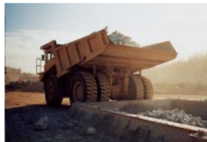
Fig. 2-7. Las rocas extraídas son llevadas por los camiones hasta los triturados primarios. (IMG12436)
