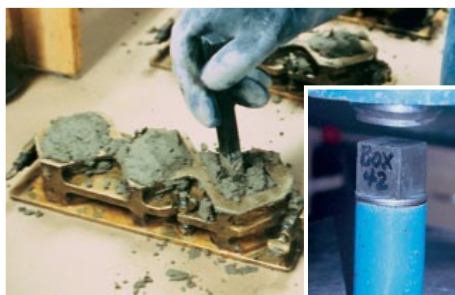
Fig. 2-41. Se hacen cubos de 50 mm (2 pulg.) (izquierda) y se los presnan para la determinación de las características de resistencia del cemento. (IMG12450, IMG12449)
