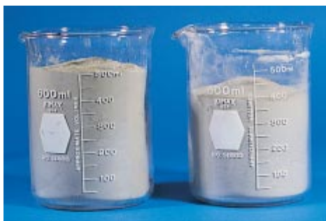
Fig. 2-48. Los dos recipientes contienen 500 gramos de polvo de cemento seco. A la izquierda, el cemento ha sido solamente colocado en el recipiente. A la derecha, el cemento ha sido ligeramente vibrado – imitando la consolidación durante el transporte o la compactación mientras que se lo almacena en los silos. La diferencia del 20% del volumen aparente enseña la necesidad de medirse el cemento por su peso y no por su volumen, al mezclarse el concreto. (IMG12444)
