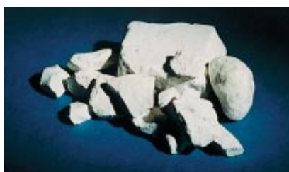
Fig. 2-11. El yeso, la fuente de sulfato, se muele juntamente con el clinker para formar el cemento portland. El yeso ayuda a controlar el tiempo de fraguado, las propiedades de contracción (retracción) por secado y el desarrollo de resistencia. (IMG12489)
