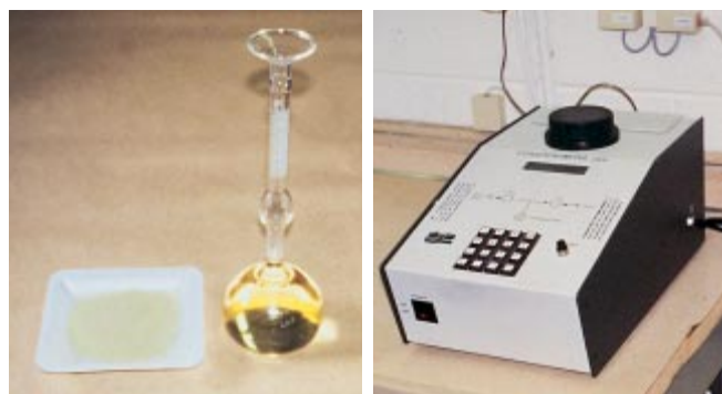
Fig. 2-47. La masa específica del cemento se puede determinar por (izquierda) el uso del frasco volumétrico de Le Chatelier y queroseno (kerosene) o por (derecha) el uso de un picnómetro de helio. (IMG12446, IMG12445)
