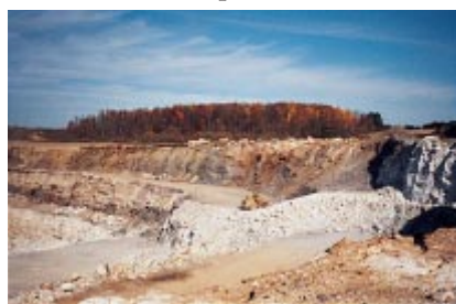
Fig. 2-6. Caliza, una de las principales materias primas, provee el calcio para la producción de cemento y se extrae cerca de la planta de cemento. (IMG12437)
