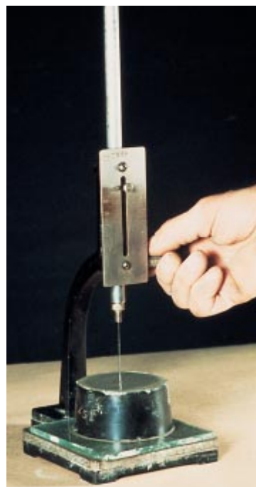
Fig. 2-38. El ensayo del tiempo de fraguado en pasta usando la aguja de Vicat. (IMG12502)
