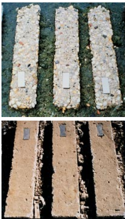
Fig. 2-15. Las muestras de pruebas usadas en el ensayo de sulfatos en ambiente externo en Sacramento, California son vigas de 150 x 150 x 760 mm (6 x 6 x 30 pulg.). Se ilustra la comparación de las tasas: (superior) la tasa de concretos de 5 hasta 12 años, preparados con cemento tipo V y relación agua-cemento de 0.65; y (inferior) la tasa de concretos de 2 hasta 16 años, preparados con cemento tipo V y relación agua-cemento de 0.38 (Stark 2002). (IMG12481, IMG12480)
