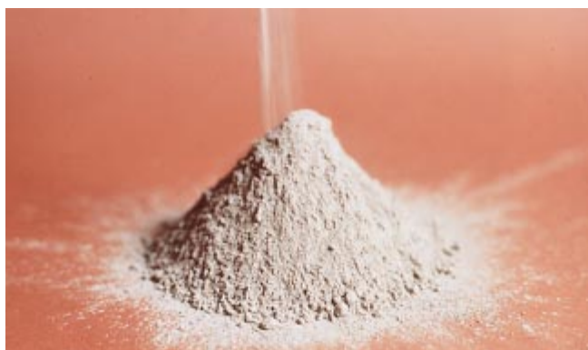
Fig. 2-1. El cemento portland es un polvo fino que cuando se mezcla con el agua se convierte en un pegamento que mantiene los agregados unidos en el concreto. (IMG12628)
