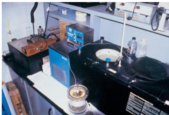
Fig. 2-44. El calor de hidratación se puede determinar por (izquierda) ASTM C 186 y por (derecha) calorímetro de conducción. (IMG12447, IMG12448)
