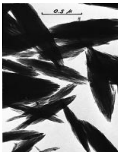
Fig. 2-26. Micrografías electrónicas de (izquierda) silicato dicálcico hidratado, (medio) silicato tricálcico hidratado y (derecha) cemento portland normal hidratado. Observe la naturaleza fibrosa de los productos hidratos de silicato de calcio. Fragmentos rotos de cristalitas de hidróxido de calcio angular también están presentes (derecha). La unión de las fibras y la adhesión de las partículas de hidratación son responsables por el desarrollo de la resistencia de las pasta de cemento portland. Referencias (izquierda y el medio) Brunauer 1962 y (derecha) Copeland y Schulz 1962. (IMG12464, IMG12463, IMG12462)
